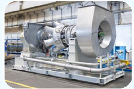
Turbinas de gas
